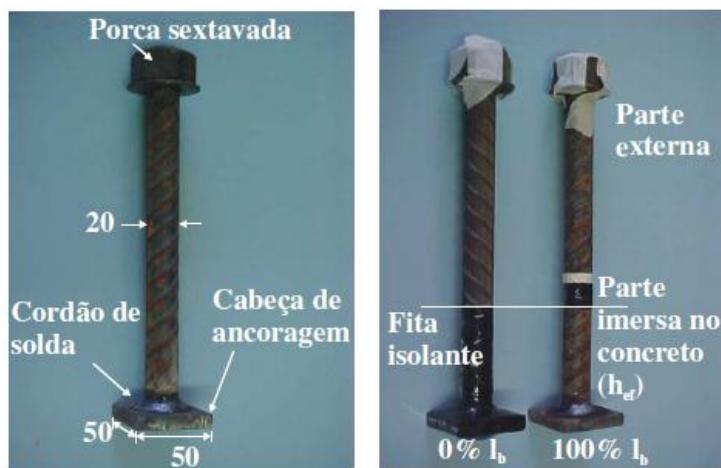
Figura 9. Configuração dos pinos preparados para concretagem
