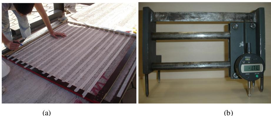
Figura 5- (a) Malha de pontos de 1m<sup>2</sup> na superfície rugosa da laje 1A; (b) detalhe do rugosímetro.
