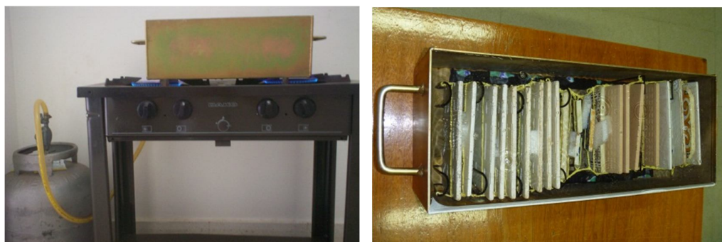
Figura 1 – Realização do ensaio de absorção de água.
