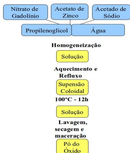
Figura 3 – Rota base da reação e arranjo experimental utilizado.
